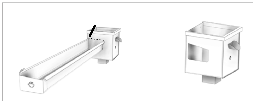
rys.5 Wykonanie otworu w bocznej ścianie kosza zlewowego w kształcie rynny.
